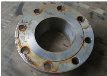
RVS304-flens die besmet is door ijzerhoudend water.
